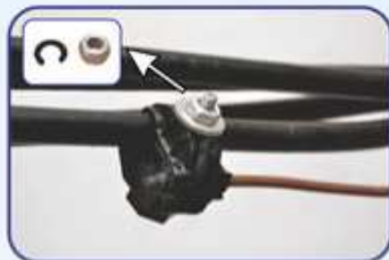
5. После срыва головки гайки нельзя дополнительно подтягивать оставшуюся часть
