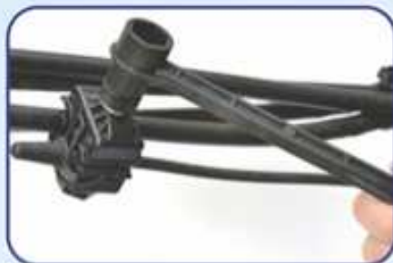
4. Затяжка верхней части головки на зажиме с помощью изолированного ключа ОК 13, в направлении по часовой стрелке
