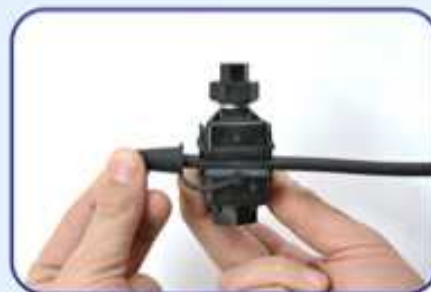
2. Подключение абонентского провода и установка изолированного колпачка
