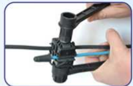
6. Для подключения абонента к магистрали сечением менее 35 мм 2 используется изолированный ключ ОК 13 и ОК 22
